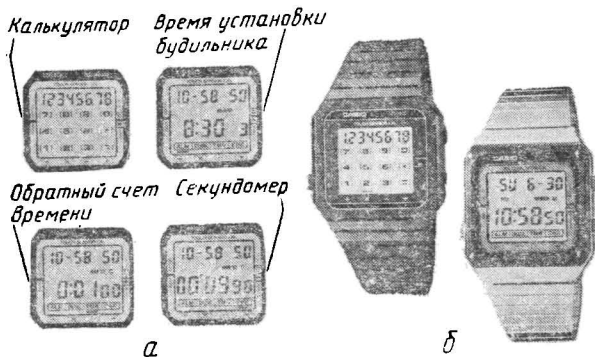
Рис. 8. Часы со встроенным микро-калькулятором и сенсорной системой управления:
